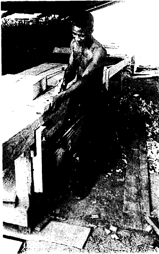
Fig.24 Dressage. Noter que cette opération consiste à raboter la rive de la planche Fig.24 Edge planing
