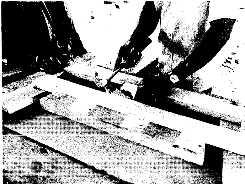
Fig.72 Coincer les deux traverses par un bloc et un coin. Taper doucement sur les bouts de côtés de membrures pour s'assurer qu'ils buttent contre le gabarit. Avec le gabarit troué de traverses marquer les trous de vis sur chaque traverse Fig.72 Tighten the two braces with a block and wedge. Tap lightly on upper ends of frame sides to ensure that bottom edges touch pattern blocks. Mark screw holes on both braces with pattern
