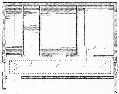
"A"-LAYOUT OF A STANDARD PACKINGHOUSE SMOKE HOUSE
