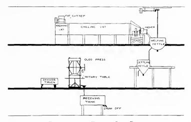
ELEVATION OF A TYPICAL OLEO PLANT
