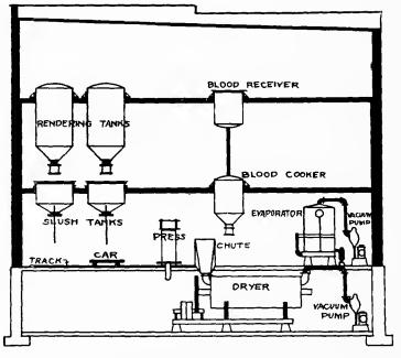
ELEVATION OF A TYPICAL TANK HOUSE
