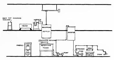
ELEVATION OF A TYPICAL KETTLE-RENDERED LARD PLANT
