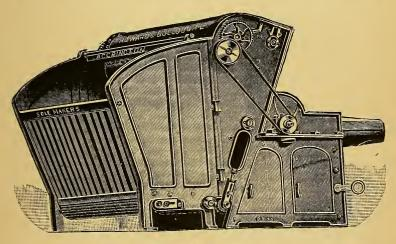
Fig. 1.-Hopper Feeder.
