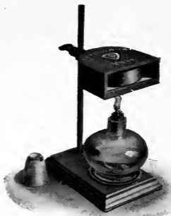
Fig. 61. The Benkendorf tester.
