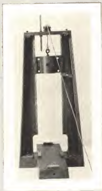
Fig. 1. A. F. A. Impact-Hammer.
