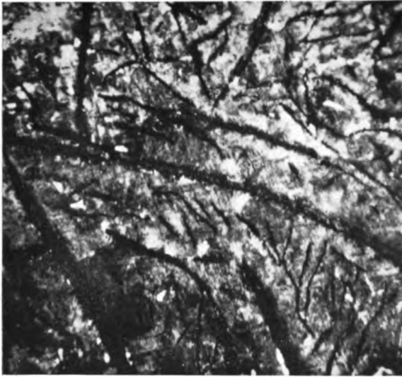
A. Graphite in cold blast charcoal pig-iron. §§301. × 100
