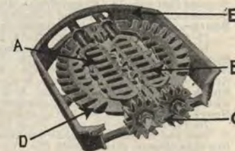
A—Long Da. Bar B—Short Da. Bar C—Cog Wheels D—Grate Ring E—Grate Frame
