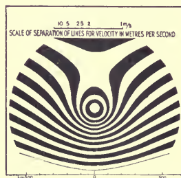
Fig. 224. Vortex 15 m/s in a stream 5 m/s
