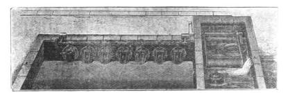
Fig. 46. RIDGWAY'S AUTOMATIC DISTRIBUTOR FOR BROAD IRRIGATION.
