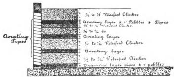
FIG. 26.-FILTERING MATERIAL.
