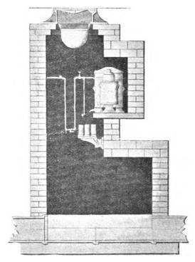
FIG. 22. REEVES' SEWER GAS DISINFECTOR.
