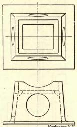
Fig. 27. Cast-iron Anvil Block
