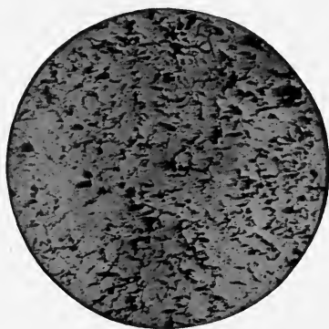
FIG. 265. — ANNEALED MALLEABLE CAST IRON.
