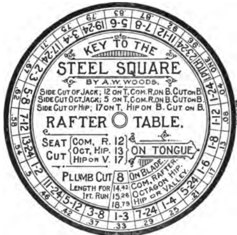
FIG. 28. STEEL SQUARE KEY
