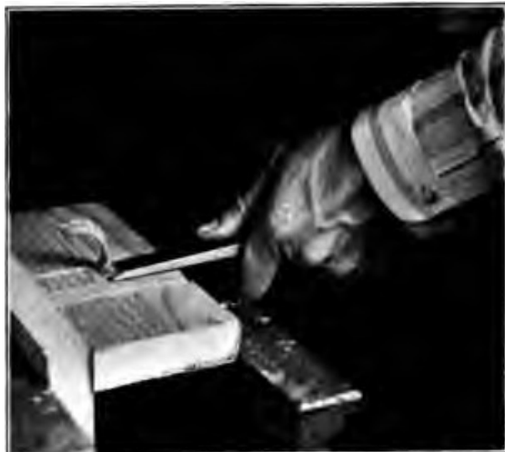
Fig. 70. Chiseling Out a Dado (First Step).
