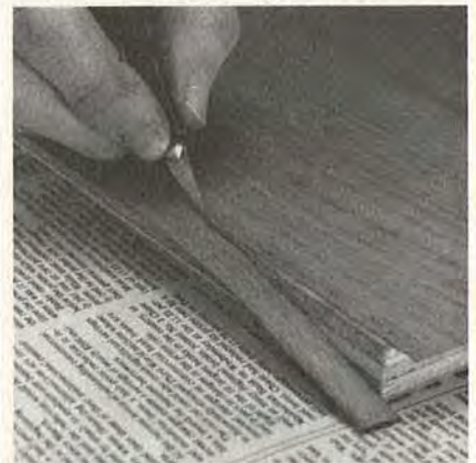
Trimming panel edge
